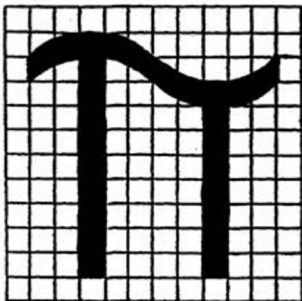
2. La altura mínima del marcado «Π» será de 5 mm. Para los equipos a presión transportables con un diámetro igual o inferior a 140 mm la altura mínima será de 2,5 mm.
